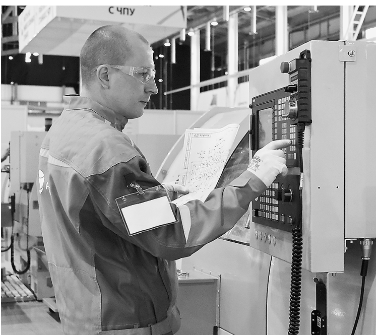
Компетенция «Фрезерные работы на станках с ЧПУ». Участники соревнований должны были изготовить за 4 часа работы сложную деталь согласно чертежу.
