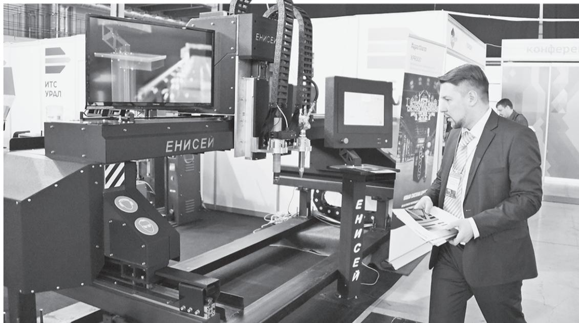
Установка для плазменной резки металлов «Енисей» – совместная разработка свердловских и красноярских инженеров.
