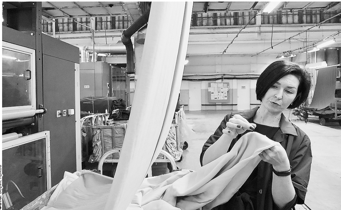
«Флис получается мягким после того, как ткань пройдет через игольчатый барабан», — рассказывает инженер-технолог Ольга Буйневич.
