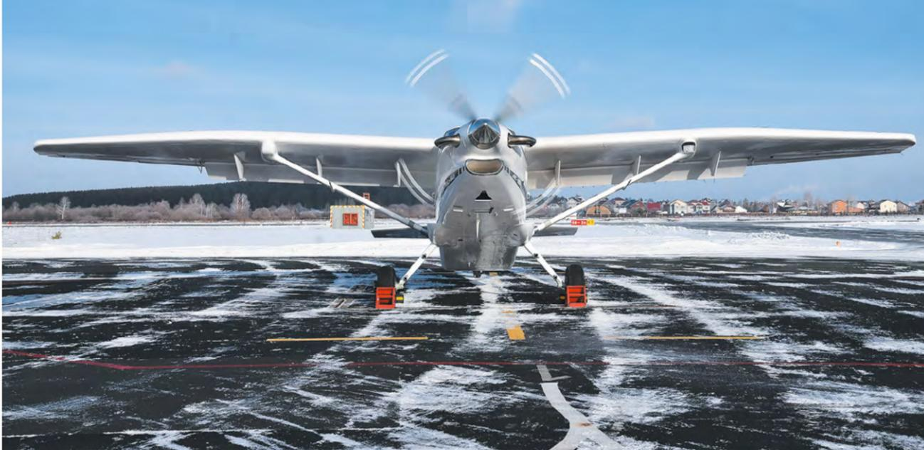
Самолеты, набирающие крейсерскую скорость 300 км/ч и готовые к полетам на две тысячи километров, уже проходят проверку в воздухе. Еще одно достоинство легких многоцелевых «Байкалов» – техника выдерживает температурные качели от –55 до +50 градусов. Самолеты, которые производят на Урале, стали самой ожидаемой новинкой гражданской авиации: и должны заменить устаревшие советские кукурузники Ан-2.
