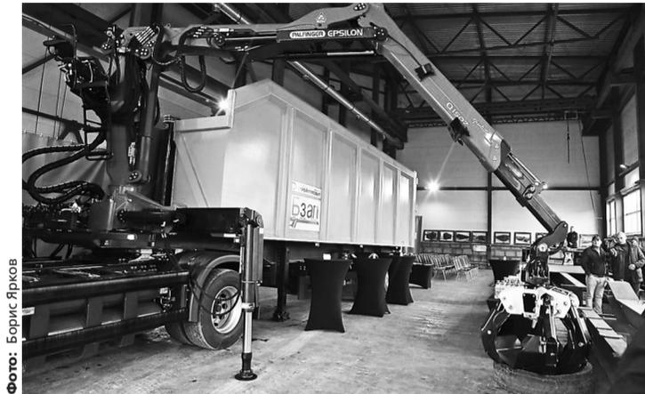
С помощью манипулятора загрузка возможна в радиусе 20 метров. В течение года завод планирует выпустить 150 прицепов. Топливная эффективность машины – 30 л, длина – 14,5 м, вместимость кузова – 50 кубометров
